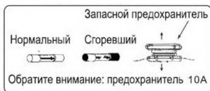
В том случае, если квадроцикл не работает или не осуществляется процесс заряда, в первую очередь, нужно проверить предохранитель. Если он вышел из строя (перегорел), следует заменить его на другой, который прилагается к изделию.
