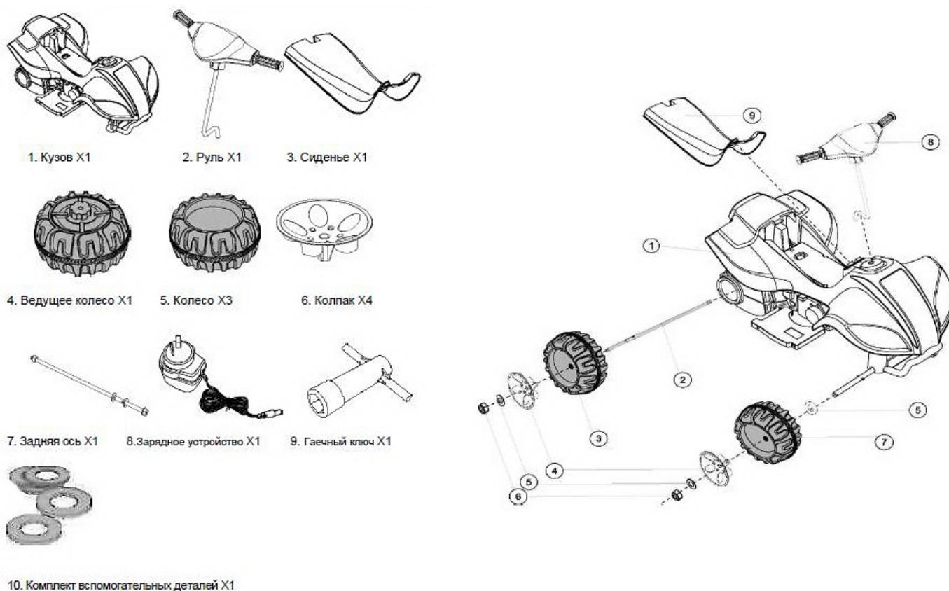
1 – кузов, 2 – задняя ось, 3 – ведущее колесо, 4 – колпак, 5 – шайба, 6 – контргайка, 7 – колесо, 8 – руль, 9 – сидение.
