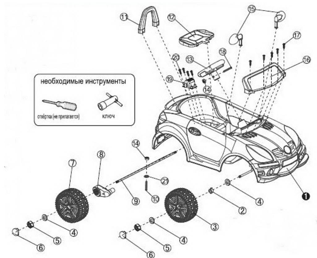
1 – кузов, 2 – втулка, 3 – колеса, 4 – шайба, 5 – контргайка, 6 – колпачок, 7 – ведущее колесо, 8 – коробка передач, 9 – задняя ось, 10 – крепежный винт, 11 – спинка, 12 – сиденье, 13 – рулевое колесо, 14 – гайка, 15 – зеркала заднего вида, 16 – окно, 17 – винты с круглой шляпкой, 18 – крепежный винт, 19 – кожух мотора, 20 – винты с круглой головкой, 21 – шайба.
