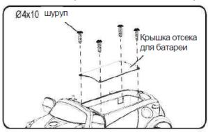
Отвинтите при помощи отвертки 4 шурупа Ø4x10 на корпусе машины. Закрепите крышку отсека для батареи 4 шурупами Ø4x10.
