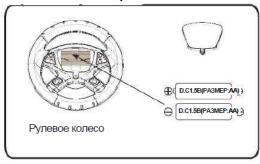
При помощи отвертки откройте крышку аккумуляторного отсека и аккуратно поместите в нишу две батарейки размера AA, верните крышку на место.
