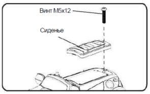
Отвинтите винт M5x12 на корпусе машины при помощи отвертки. Закрепите сиденье на корпусе машины винтом M5x12.
