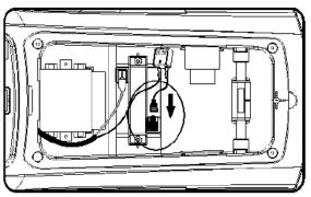
Переверните корпус машины. Вставьте коннектор в терминал батареи, как показано на рисунке.
