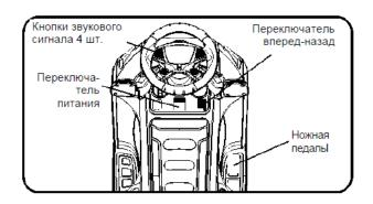
ВАЖНО! Всегда останавливайте машину перед изменением скорости или направления движения для предотвращения выхода из строя редуктора или двигателя.
