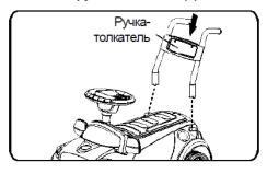
Установите трубки ручки-толкателя в гнезда, расположенные в задней части машины. Надавите до характерного щелчка фиксации (не применяйте чрезмерных усилий).
