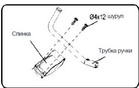
Установите ручку-толкатель в нишу. Закрепите ручку при помощи 2 шурупов Ø4x12 и отвертки.
