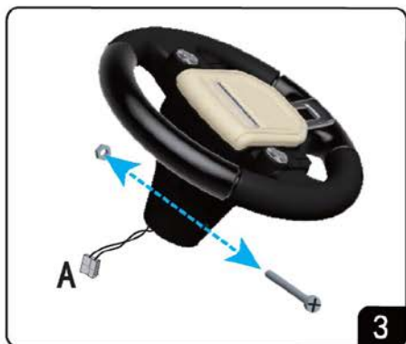
3.1 Рис. 3: С помощью отвертки ослабьте винт рулевого колеса.
