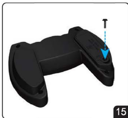
6.4 Рис. 15: Зафиксируйте крышку батарейного отсека винтом.
