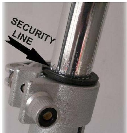
4. Момент затяжки резьбового стержня седла и подседельного штыря не менее 19,6 Нм, глубина вставки подседельного штыря должна составлять порядка 2,5 диаметра подседельного штыря. Подседельный штырь должен быть зафиксирован на таком уровне, чтобы не была видна линия отметки безопасного крепления подседельного штыря – The security line (см. рисунок).
